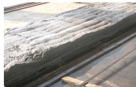
**Figura 2: Esempio di cedimento di cls alveolare a causa di errata consistenza**
