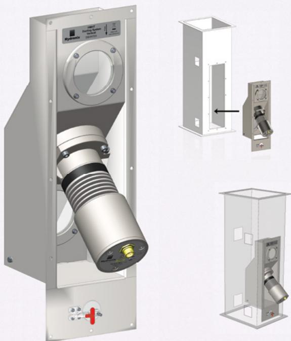
Hydronix ha desarrollado un sistema de canales para el sensor Hydro-Mix HT. Así, resulta más sencillo instalar el sensor en la posición correcta para obtener los resultados de medición de humedad más precisos. Hydronix recomienda que nuestro sistema se utilice en todas las aplicaciones de canales a modo de apoyo para el Hydro-Mix HT.
