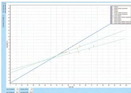
Les sondes Hydronix peuvent être étalonnées pour produire directement un pourcentage d'humidité ou une valeur Brix. Une simple interface permet à l'utilisateur de sélectionner le mode d'étalonnage le mieux adapté et de saisir, analyser, vérifier et enregistrer les données d'étalonnage.
