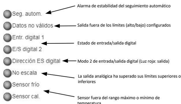
**Ilustración 84: Estado del sensor de corriente**
