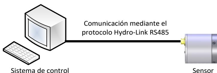
Ilustración 16: Sistema existente
