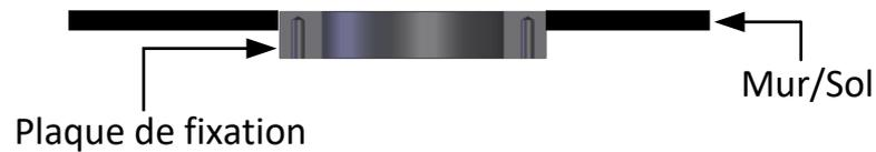
Figure 22 : Plaque de fixation montée en affleurement
