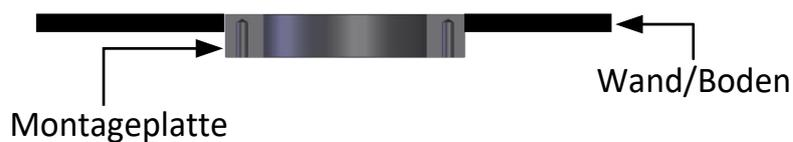
Abbildung 22: Bündig montierte Montageplatte
