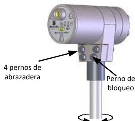
Ilustración 15: Ajuste del ángulo de la cabeza del sensor
