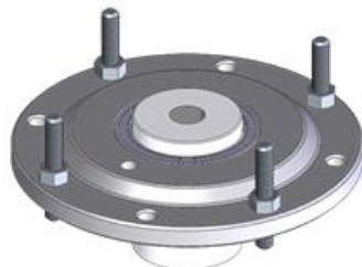
Ilustración 24. Espárragos de montaje instalados
