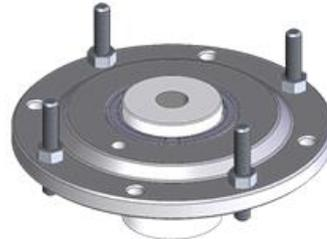
**Abbildung 24: Montagebolzen eingebaut**
