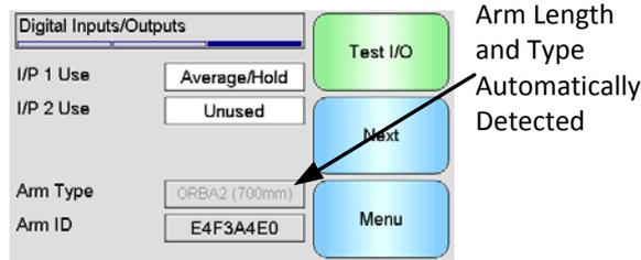
**Figure 35: Hydro-Probe Orbiter Arm Selection**
