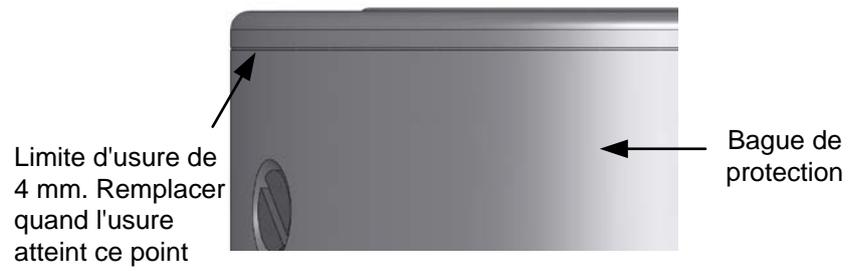
**Figure 38 : bague de protection**
